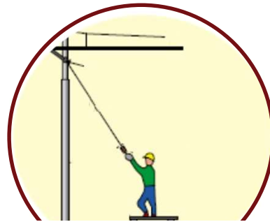
PRESENZA DI CONDUTTORI NUDI IN TENSIONE
