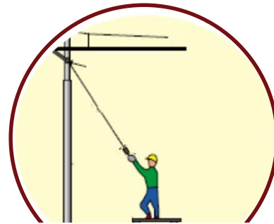
PRESENZA DI CONDUTTORI NUDI IN TENSIONE
